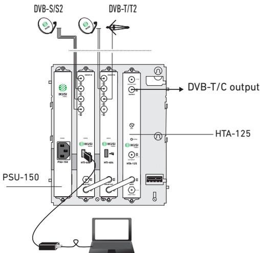
Cabecera para 7 transpondedores TV satélite o múltiplex TDT. Contiene 2 transmoduladores HTI-404, 1 fuente de alimentación PSU-150 y un amplificador de potencia HTA-125, instalados en una base BACK-500.
