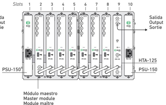
La señal multicanal DVB-T/DVB-C queda disponible en el conector inferior del último módulo de la cascada. Esta señal se conecta entonces al módulo amplificador HTA-125 en caso de ser necesario. El extremo libre de la cascada debe cargarse con 75Ω.
